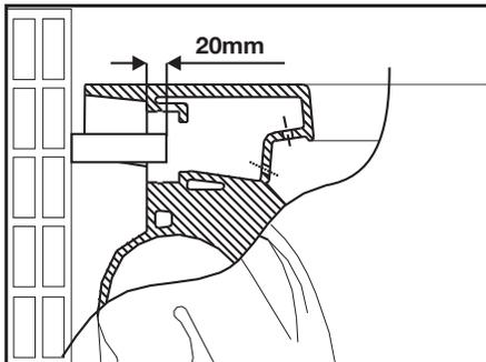
**12** Insertar y ajustar los tornillos de fijación.
